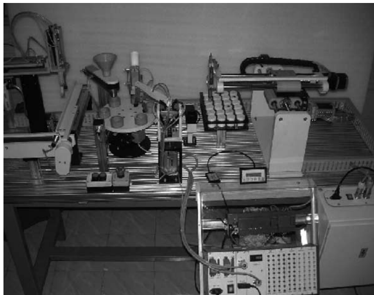
RAJAH 3. Sistem automasi pembotolan MAPS
